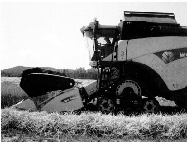
写真3. ゴムクローラ装着コンバイン
